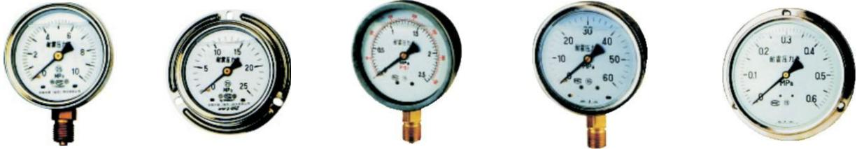
耐震压力表主要用于：合金、电力、石油、化工、轻工、机械等工业部门的压力检测。压力表依靠内部充灌阻尼油和配套缓冲装置等措施，具有良好的耐震性能。适用于被测介质的压力有强烈脉冲变化或压力冲击和在生产工艺中经常突然卸荷的场合；以及环境震动较大的场所。仪表能测量气体、液体脉动压力的平均值，以克服介质强烈脉冲及环境震动对仪表带来的损害，确保读数的准确性。
